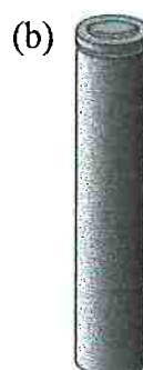
Figura 3.3 – (a) Foto do acumulador encontrado dentro das baterias de íon Li. (b) Desenho esquemático do acumulador encontrado dentro das baterias de íons de Li.
