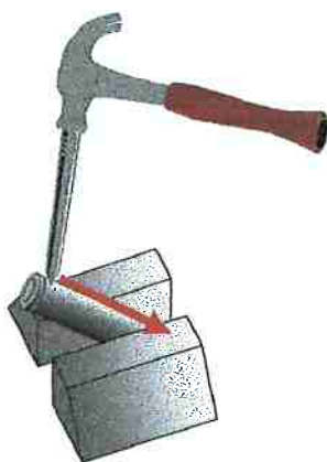
Figura 3.9 – Esquema da abertura dos acumuladores.
